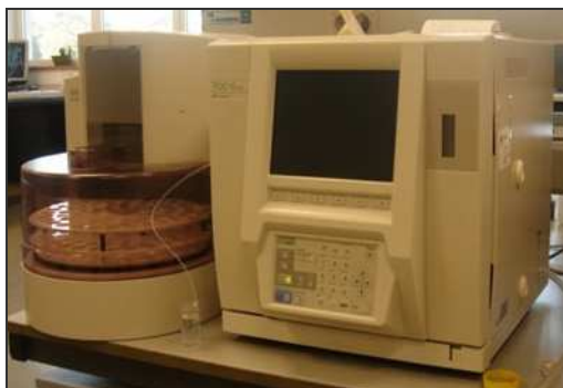
Figura 6: Sistema de medición TOC con automuestreador
