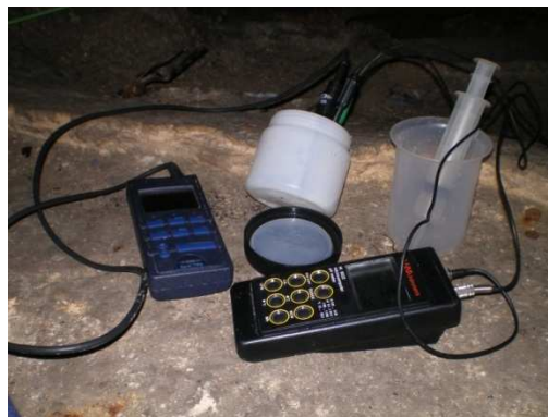
Fig. 2.5: Muestreo del agua de goteo mediante peachímetro y conductímetro portátiles
