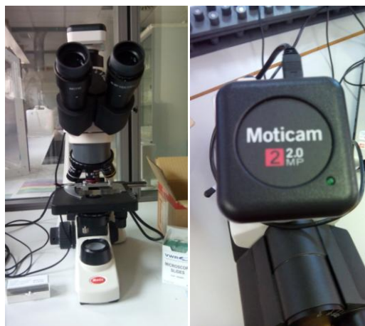
Figura 4. Microscopio trinocular BA210 Motic a la izquierda y cámara digital Moticom a la derecha (elaboración propia).
