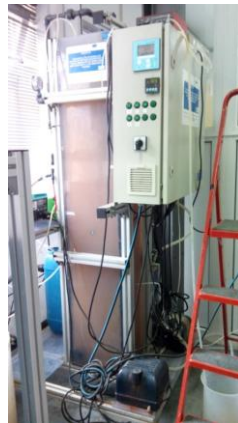
Figura 3. Biorreactor de membrana sumergida externa de 90L y panel de control (elaboración propia).
